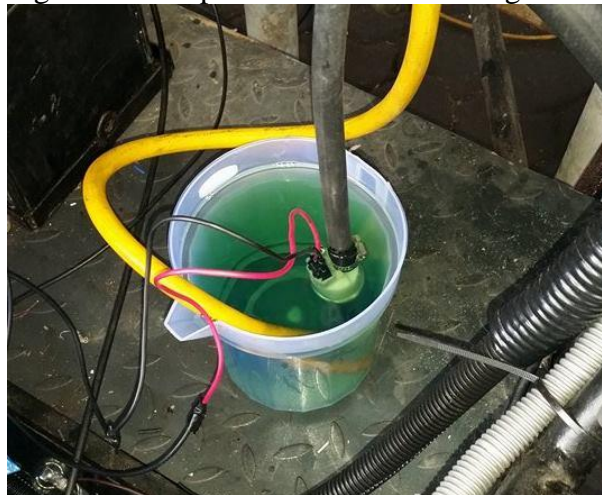
Figura 62. Adaptación de la bomba de gasolina
