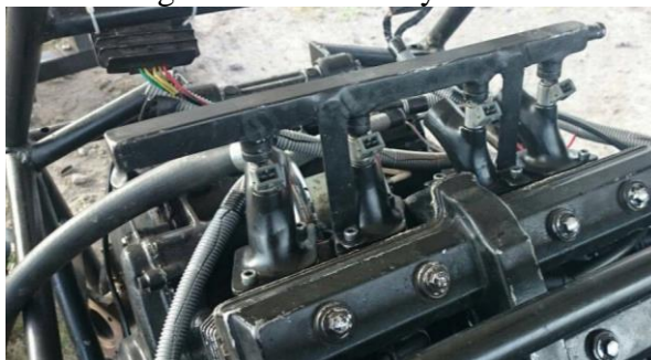
Figura 34. Riel de inyectores
