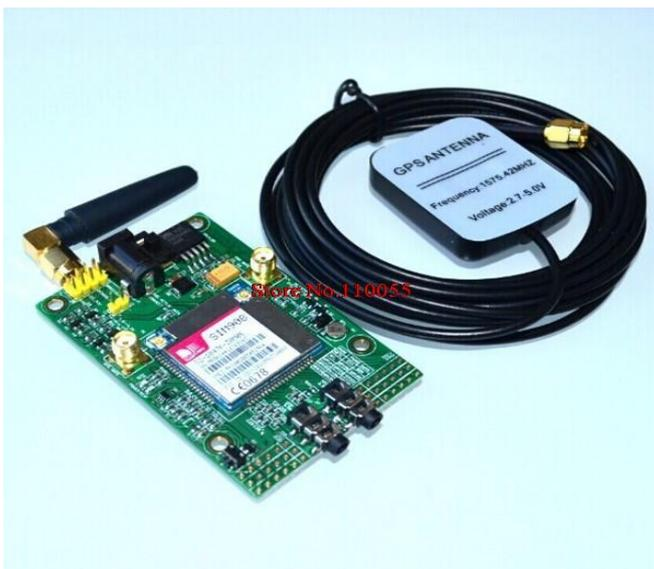
**Figura 2-31** Módulo GSM para el envío de mensajes al usuario
