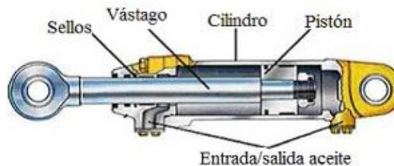
**Figura 21-1.** Partes de un cilindro de doble efecto
