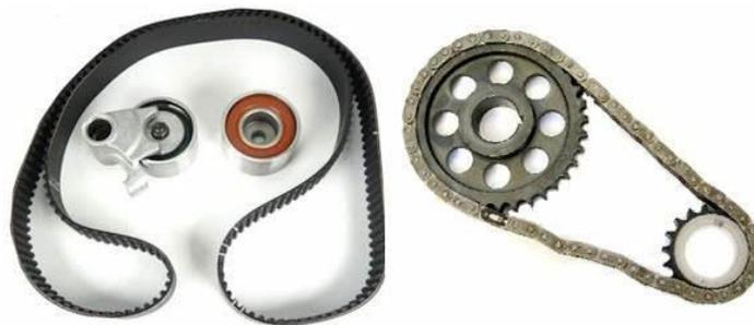
**Figura 17-1.** Correa y cadena de transmisión
