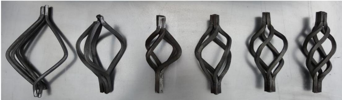
**Figura 6-3.** Evolución de pruebas en el formado de piñas
