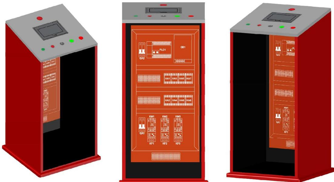
**Figura 12-2.** Diseño del gabinete para el montaje del tablero y panel frontal
