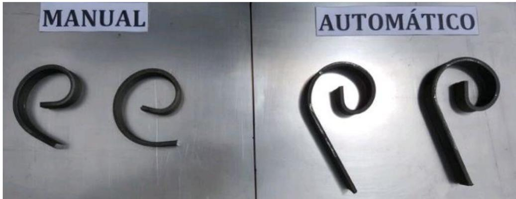
**Figura 11-3.** Comparación de voluta (manual y automático)
