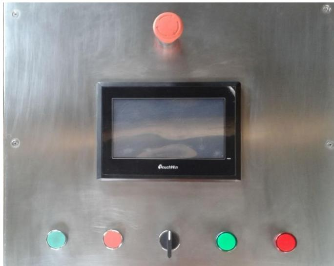
**Figura 13-2.** Disposición de los elementos de mando y HMI
