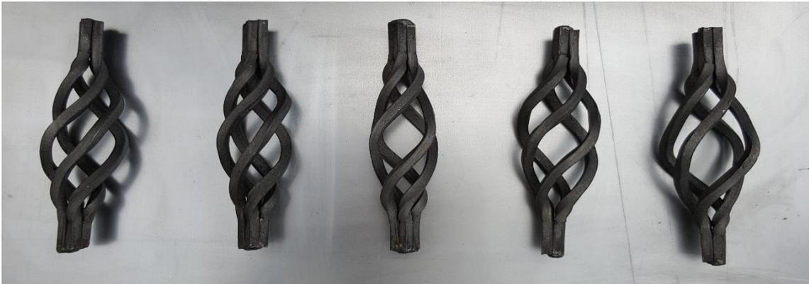
**Figura 15-3.** Piñas terminadas con diferentes parámetros para el formado
