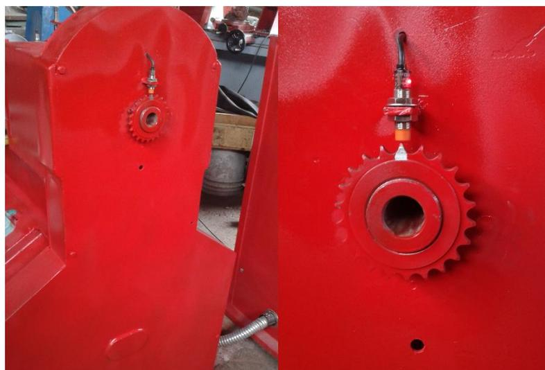
**Figura 20-2.** Sensor inductivo contador de pulsos
