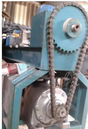
**Figura 18-2.** Motorreductor y cadena
