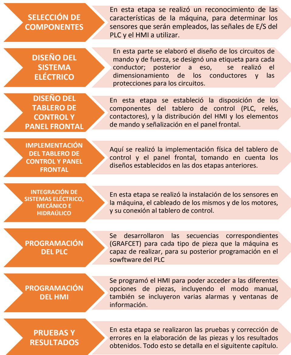
**Figura 1-2.** Etapas para la automatización de la máquina torsionadora de forja
