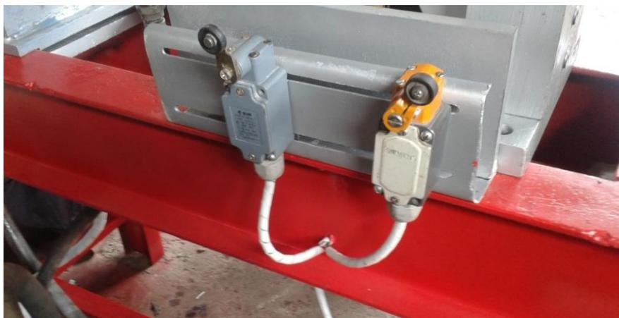
**Figura 22-2.** Sensores de posición del cilindro hidráulico
