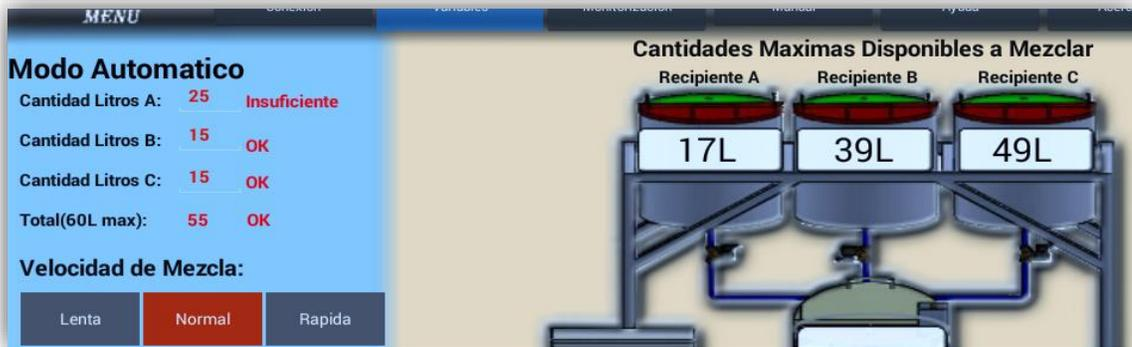
**Figura 29-2 Error Cantidades de mezcla HMI.**
