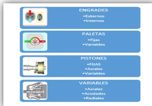
**Figura 26-1 Clasificación de las bombas hidráulicas.**
