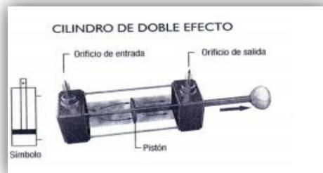
**Figura 22-1 Cilindro Doble Efecto.**
