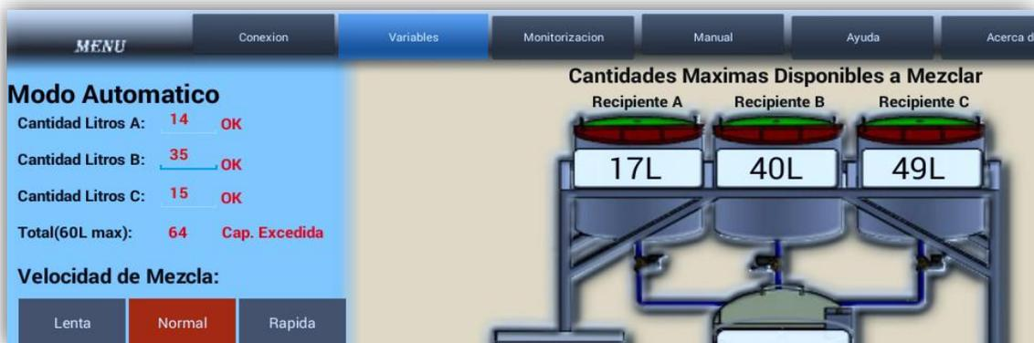
**Figura 30-2 Error Suma de Cantidades de mezcla HMI.**
