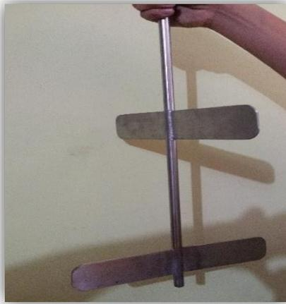
**Figura 17-3 Agitador paleta plana en acero Inox 304.**
