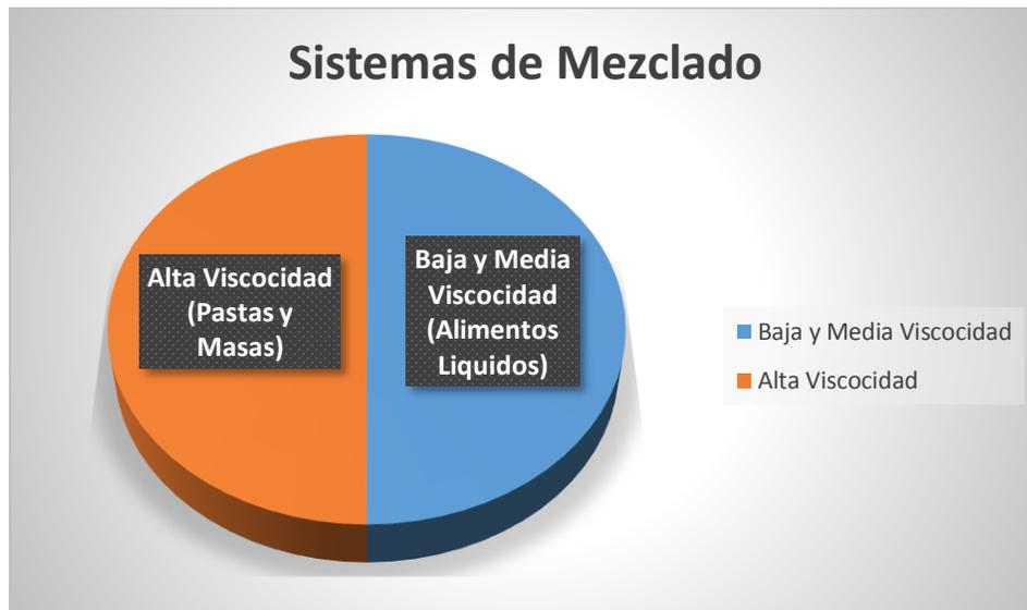
**Figura 1-3 Sistemas de Mezclado según la viscosidad de fluido.**
