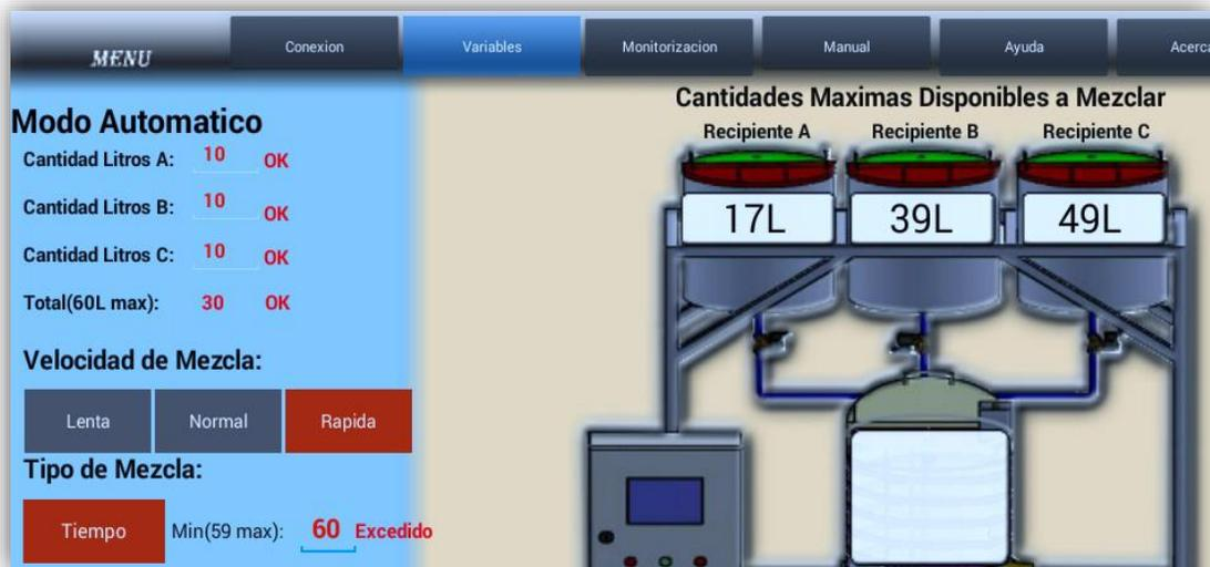
**Figura 31-2 Error tiempo de mezcla HMI.**
