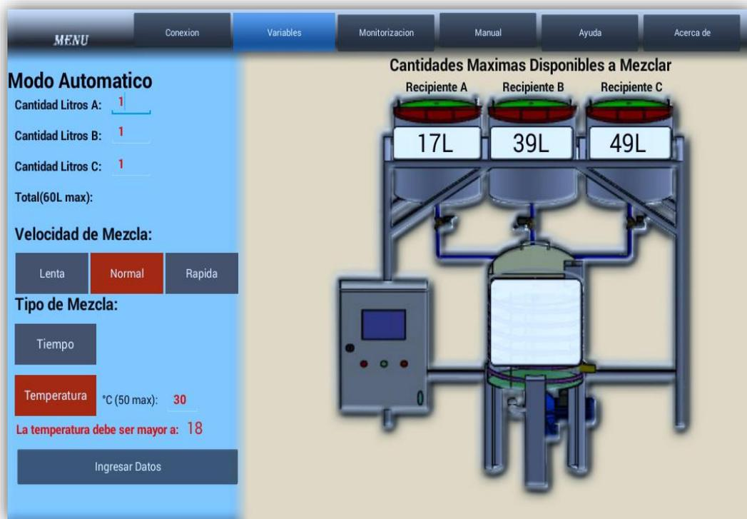
**Figura 26-2 Modo Automático Ingreso de Variables HMI.**
