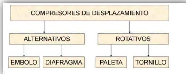
**Figura 16-1 Tipos de compresores.**
