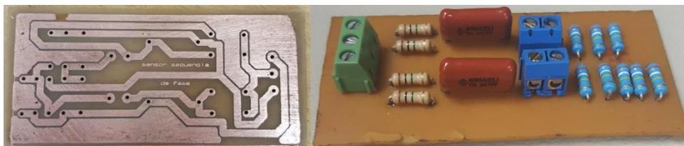
**Figura 17-2 Placa del Circuito de Secuencia de Fase**
