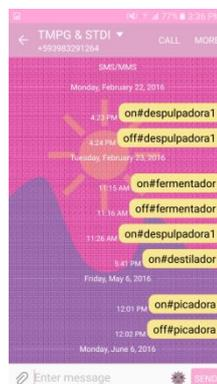
**Figura 41-2 Comandos SMS para Encendido y Apagado**
