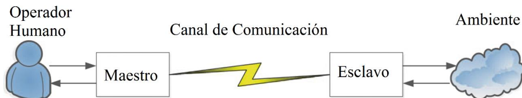
Figura 6-2. Componentes de un Sistema de Tele-Operación
