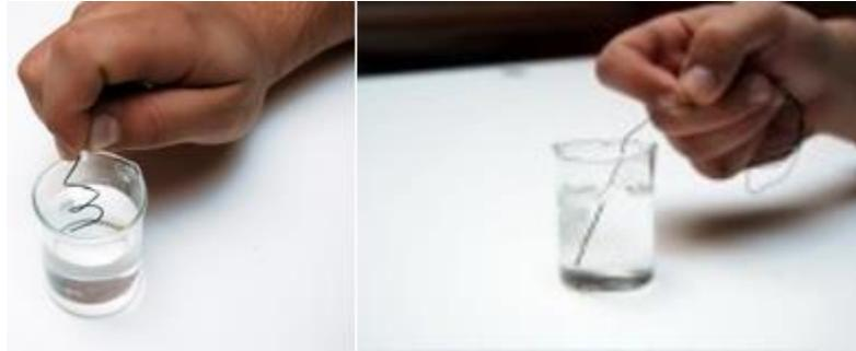
**Figura 14-1:** Reacción del Nitinol
