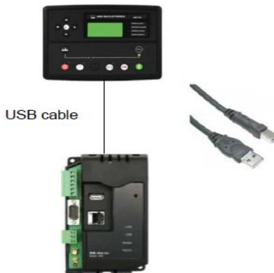
**Figura 39-2:** Conexión del controlador principal con el módulo de comunicación.
