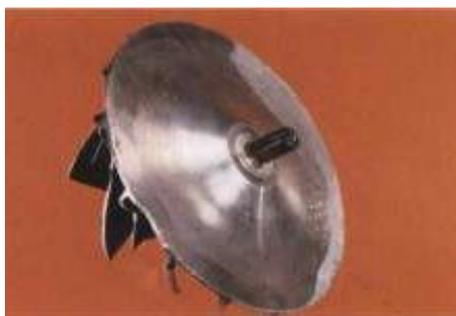
**Figura 127-2** Fractura con evidencia de deformación.
