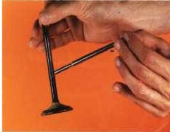
**Figura 114-2** Comprobación de soldadura
