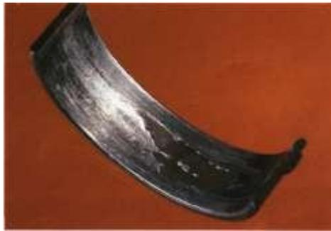
**Figura 84-2** Falla en la unión de cojinete.
