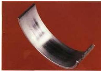
**Figura 43-2** Desgaste del cojinete
