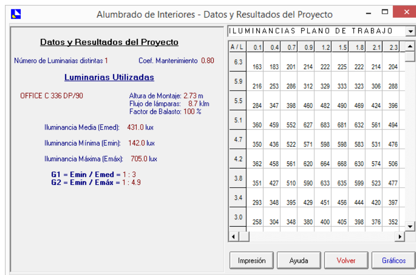
Figura. 12-3 Resultados del proceso de cálculo de iluminancia del Laboratorio MAC Elaborado por: QUINDE, Isabel 2016 Fuente: (LumeNac, 2009)
