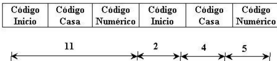
Figura 5-2 Codificación X-10 Fuente: (Domótica viva, S.L, 2002)
