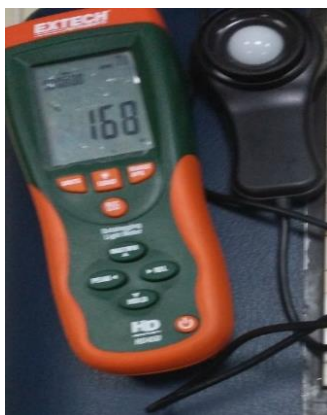
Figura. 13-3 Toma de datos de iluminancia en una zona del Laboratorio MAC
