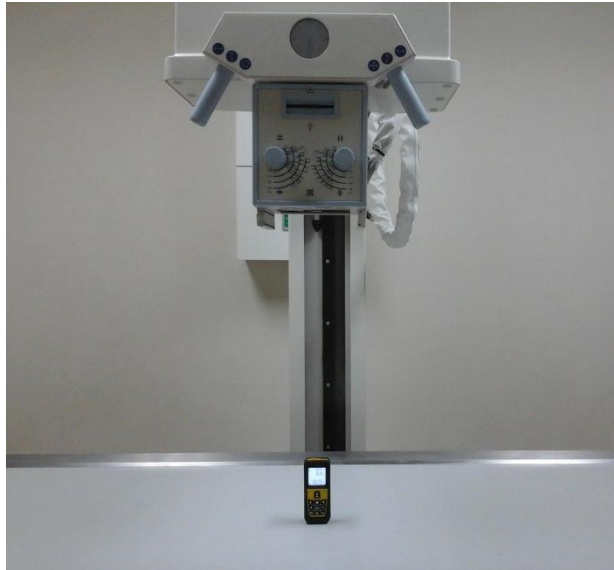
Figura 5-3. Prueba indicador de la distancia foco-detector de imagen
