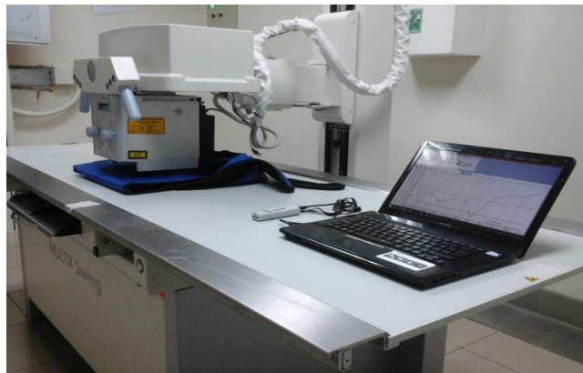
Figura 3-3. Posicionamiento de los equipos para prueba de radiación de fuga Realizado por: David Moreno
