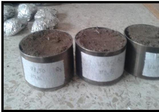
**Fotografía 2-2.** Medición de la muestra de suelo en cilindros
