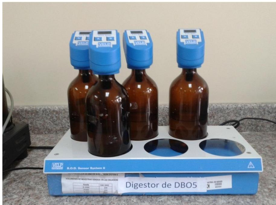
**Fotografía 10-K:** Análisis de  $\text{DBO}_5$  en el Laboratorio
