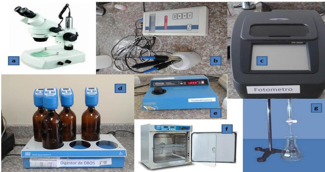
**Fotografía 2-J:** Equipo de Laboratorio: a) Estereoscopio TRINOCULAR NEXIUS ZOOM NZ.1903-S (macroinvertebrados), b) pH metro Consort C562, c) Fotómetro HACH DR 2800, d) Digestor de DBO5 BOD TRAK II, e) Turbidímetro HACH RATOR X, f) Incubadora IGS750 MARCA THERMO SCIENTIFIC, g) Bureta
