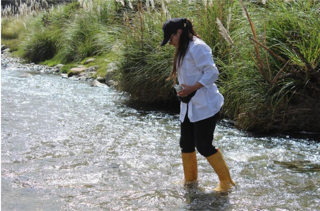
**Fotografía 7-J:** Muestreo de agua para análisis de Oxígeno Disuelto
