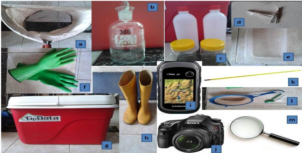
**Fotografía 1-J:** Equipo de Campo para el Monitoreo: a) red tipo D, b) botella wheaton, c) botellas pvc 1L y frascos, d) pinzas, e) bandeja, f) guantes, g) cooler, h) botas, i) GPS Garmin, j) Cámara, k) Termómetro, l) cedazo y cucharas, m) lupa.
