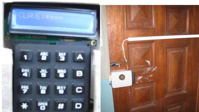
*Fig V.67: Prueba de funcionamiento de la clave de acceso*
