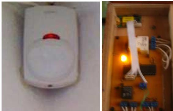
*Fig V.69: Prueba del sensor de presencia y LED indicador*
