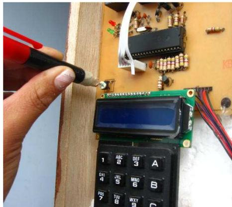
*Fig V.60: Calibración del LCD*
