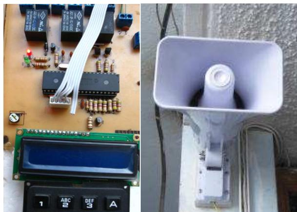
*Fig V.68: Prueba de la sirena al detectar presencia*
