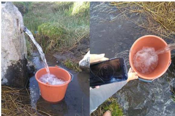
Fotografía 5-2: Determinación del caudal por método volumétrico Realizado por: Yadyra Lara, 2016
