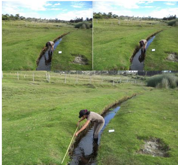
Fotografía 4-2: Determinación del caudal por método velocidad-área Realizado por: Yadyra Lara, 2016
