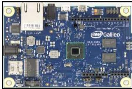
**Figura 21-1** Tarjeta Galileo.
