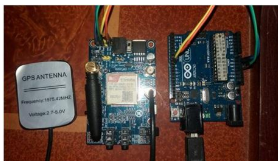
Figura 8-2 Conexión SIM 808, Antena GPS y Arduino Uno
