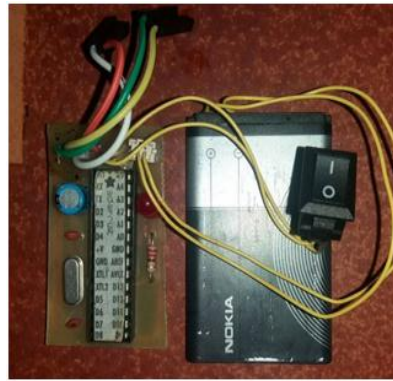
Figura 12-2 Implementación de la placa de Control
