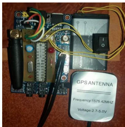
Figura 13-2 Conexión SIM808, Antena GPS y Placa de Control
