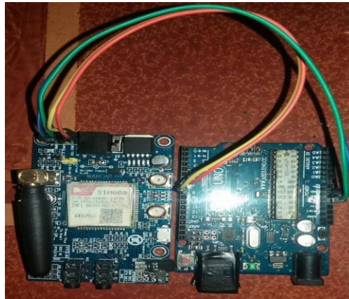
Figura 7-2 Conexión SIM 808 y Arduino Uno
