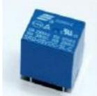
Las salidas de las placas Arduino son perfectamente útiles para controlar cargas que no consuman demasiada corriente, como un Led, pero son insuficientes para cargas mayores. ¿Cómo hacemos para controlar por ejemplo una lámpara o un motor que se alimentan de 220 voltios? Una forma es emplear un módulo de relés como el que analizo en este artículo.
