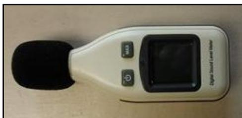
**Figura 3-2** Sonómetro Sound Level Meter
