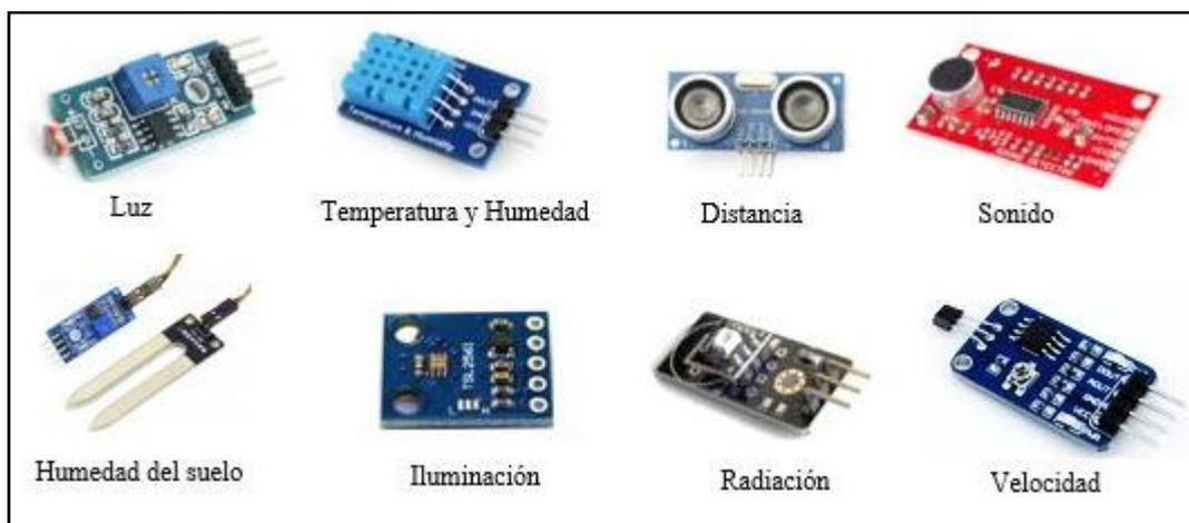
**Figura 1-3** Ejemplos de sensores
