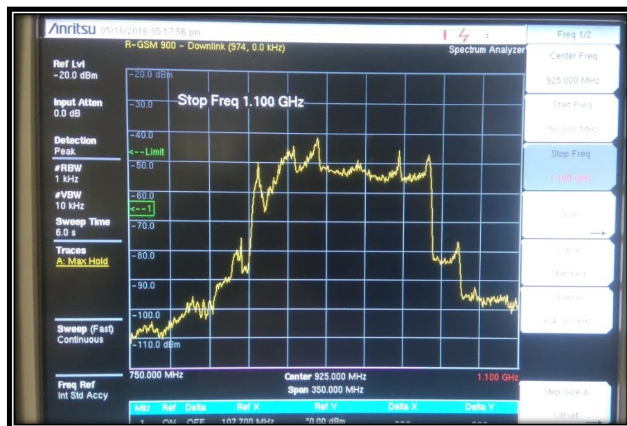
Figura 3-17 Análisis de la señal 2G con el jammer encendido.
