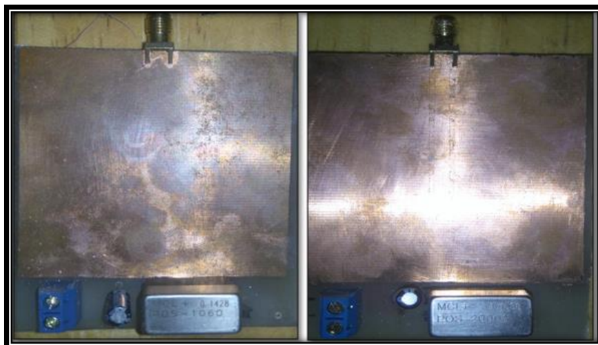
Figura 3-9 Parte delantera de la placa RF para 850MHz y 1900MHz.
