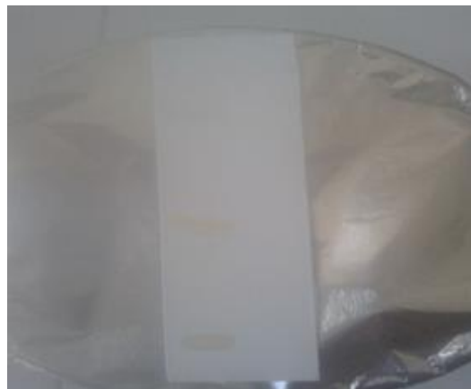
Cromatografía en capa fina utilizando Tolueno/Metanol (3:1) como solvente sin revelar
