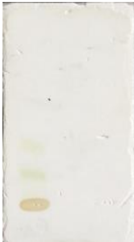
Cromatografía en capa fina utilizando Cloroformo/Metanol (0.5:1.5) como solvente
