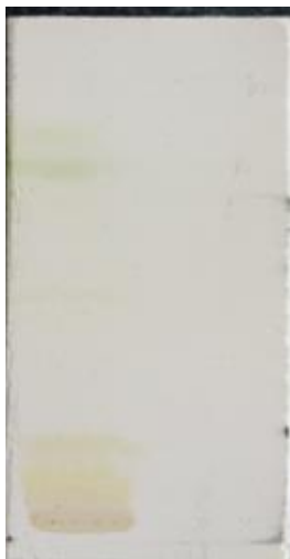
Cromatografía en capa fina utilizando Tolueno/Metanol(1:1) como solvente
