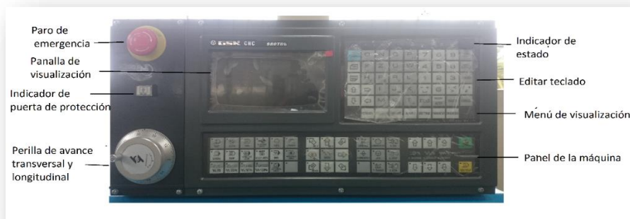
Figura 19. Tablero de control
