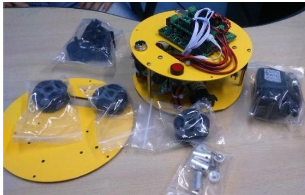
**Figura 11-2.** Ensamblaje base omnidireccional.
