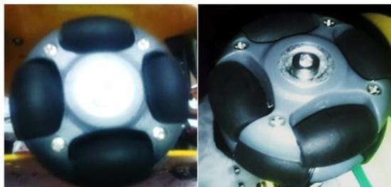
**Figura 8-1.** Rueda 48mm omnidireccional
