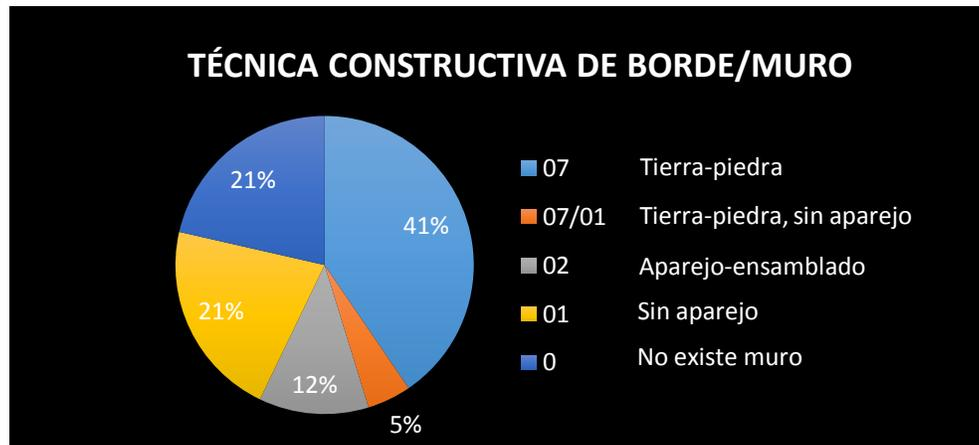
**Figura 55.** Técnica constructiva de borde/muro de la vía precolombina tramo Sevilla- Nizag
