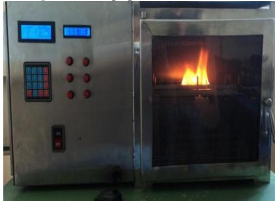
**Fuente:** Diseño y construcción de un equipo para ensayos de inflamabilidad aplicado a materiales de auto partes según la norma ISO 3795.
