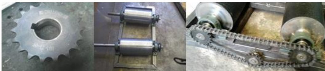
Figura 59. Chavetero en la catalina y montaje de chumaceras catalinas y la cadena
