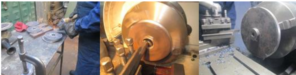
Figura 52. Fabricación de las tapas de los rodillos
