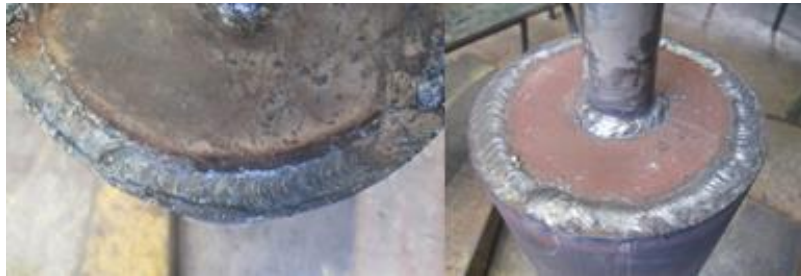
Figura 54. Soldadura en el rodillo
