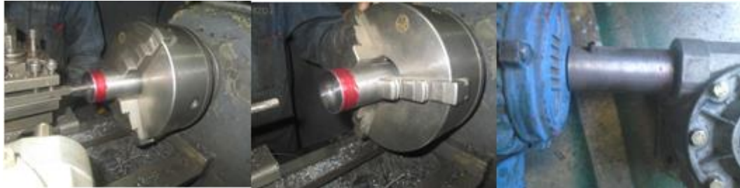
Figura 60. Fabricación acople motor-caja reductora
