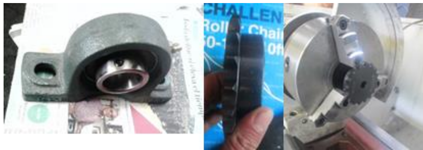
Figura 58. Chumacera, catalina y perforación de la catalina
