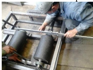
Figura 68. Centrado de los rodillos respecto al conjunto motriz
