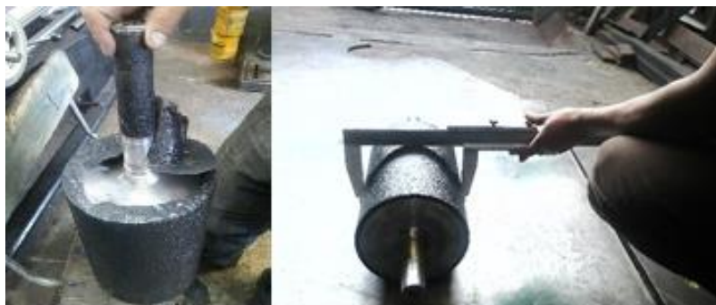
Figura 56. Recubrimiento de los rodillos
