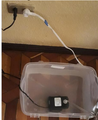
Figura 42. Bomba para el sistema de refrigeración
