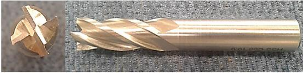
Figura 38. Fresa Plana HSS de Ø6 mm y número de dientes 4
