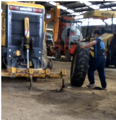
Figura 32. Puesto cambio de neumático – transporte del neumático
