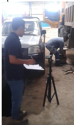
Figura 65. Medición del ruido - puesto de cambio de neumático para motoniveladora
