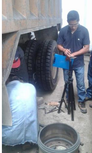
Figura 63. Medición del ruido - puesto de cambio del filtro de aceite para volquetas
