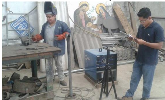
Figura 64. Medición del ruido - puesto de soldadura
