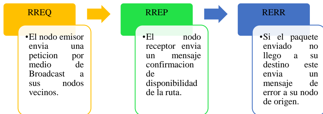
Figura 6.1 Proceso de funcionamiento del protocolo de enrutamiento de AODV
