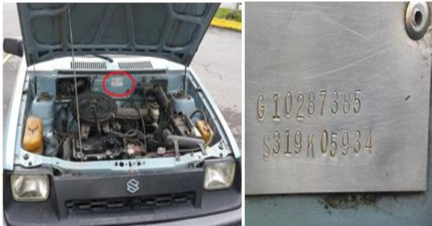
**Figura 3-1:** Número de la serie del chasis de un Suzuki Forsa 1
