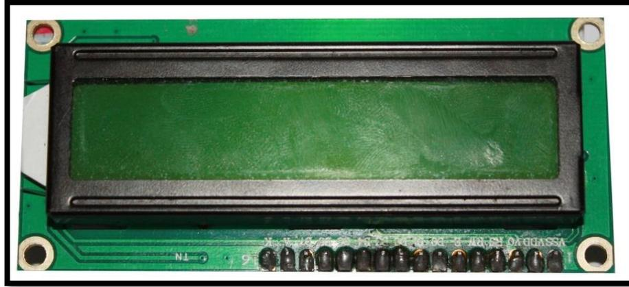
**Figura 10-2:** Pantalla de Cristal Líquido 16x2
