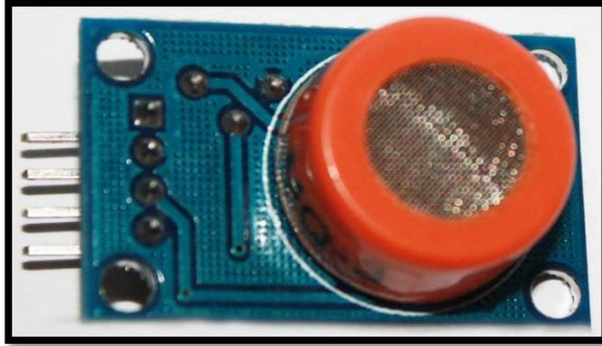
**Figura 6-2:** Sensor de Alcohol MQ-3
