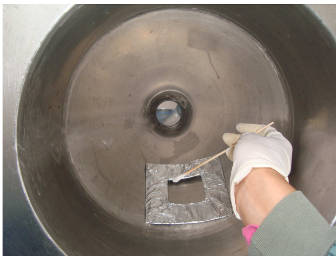
FOTOGRAFÍA No.9. TOMA DE MUESTRAS DE RESIDUOS DE LA TOLVA DESPUES DE LA LIMPIEZA
