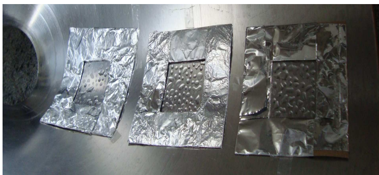
FOTOGRAFÍA No.13. CONTAMINACIÓN CON ESTANDAR EN LA TOLVA PARA LA OBTENCIÓN DEL FACTOR DE RECUPERACION
