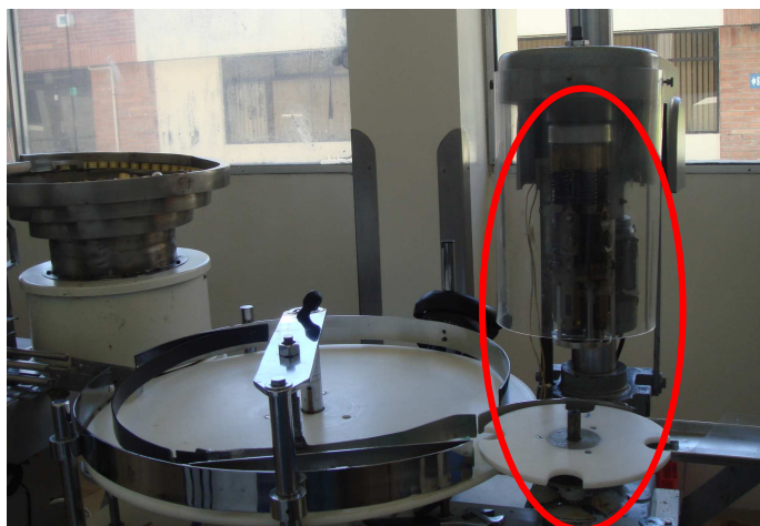
FOTOGRAFÍA No. 5. PUNTO CRITICO, SELLADORA
