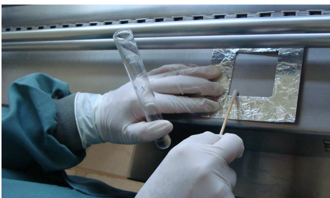
FOTOGRAFÍA No.11. TOMA DE MUESTRAS DE RESIDUOS DE LA BANDA DESPUES DE LA LIMPIEZA, DESPUES DE LA PRODUCCIÓN DE AMOXICILINA
