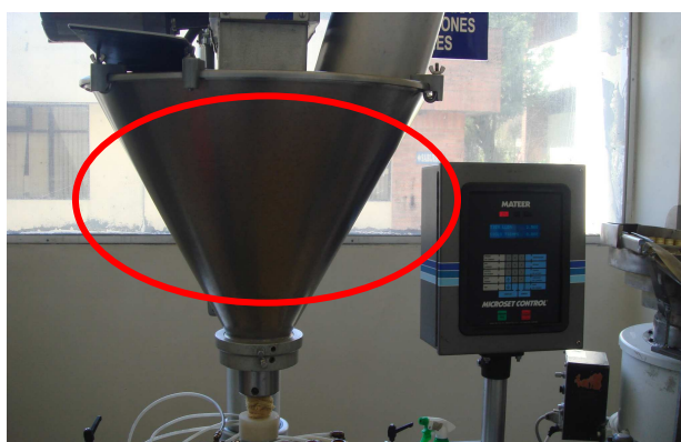
FOTOGRAFÍA No. 2. PUNTO CRITICO, TOLVA PARTE SUPERIOR
