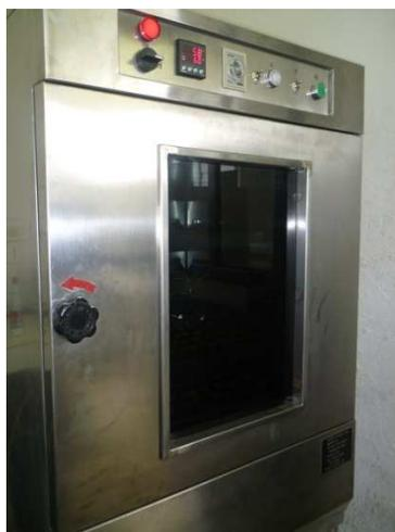
**FOTOGRAFÍA No. 1 Secador de bandejas.**
