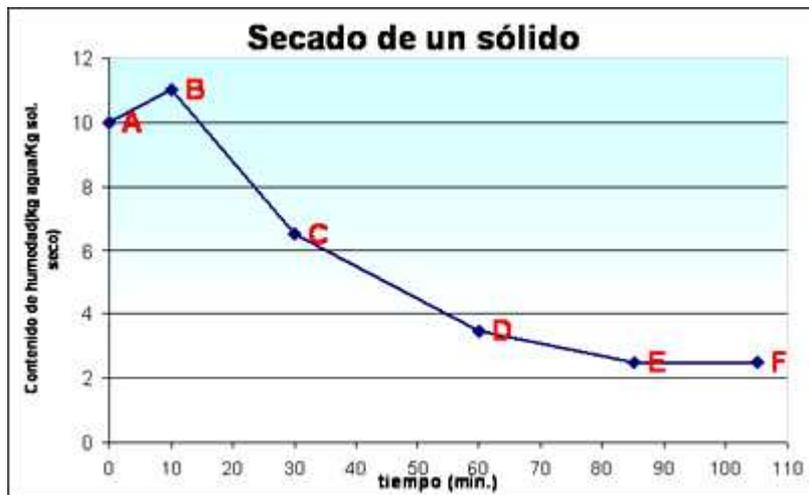
FIGURA No. 6 Perfil de secado de un sólido
