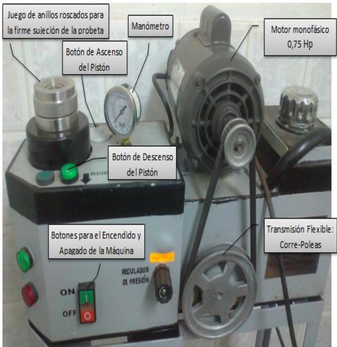
Fotografía 7. Máquina para el test de lastometría.
