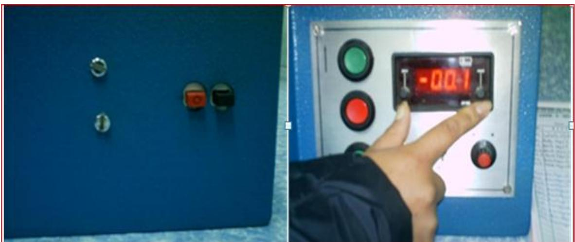
Fotografía 5. Encendido del equipo para medir la resistencia a la tensión del cuero.
