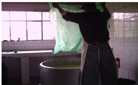
Foto 11: Malla utilizada para retener el cuajo y separar el suero
