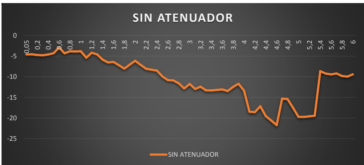
Figura 3-18: Grafica de módulo de amplificación de 0.05-6 GHZ
