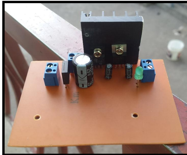
Figura 3-3: Fuente de alimentación componentes internos
