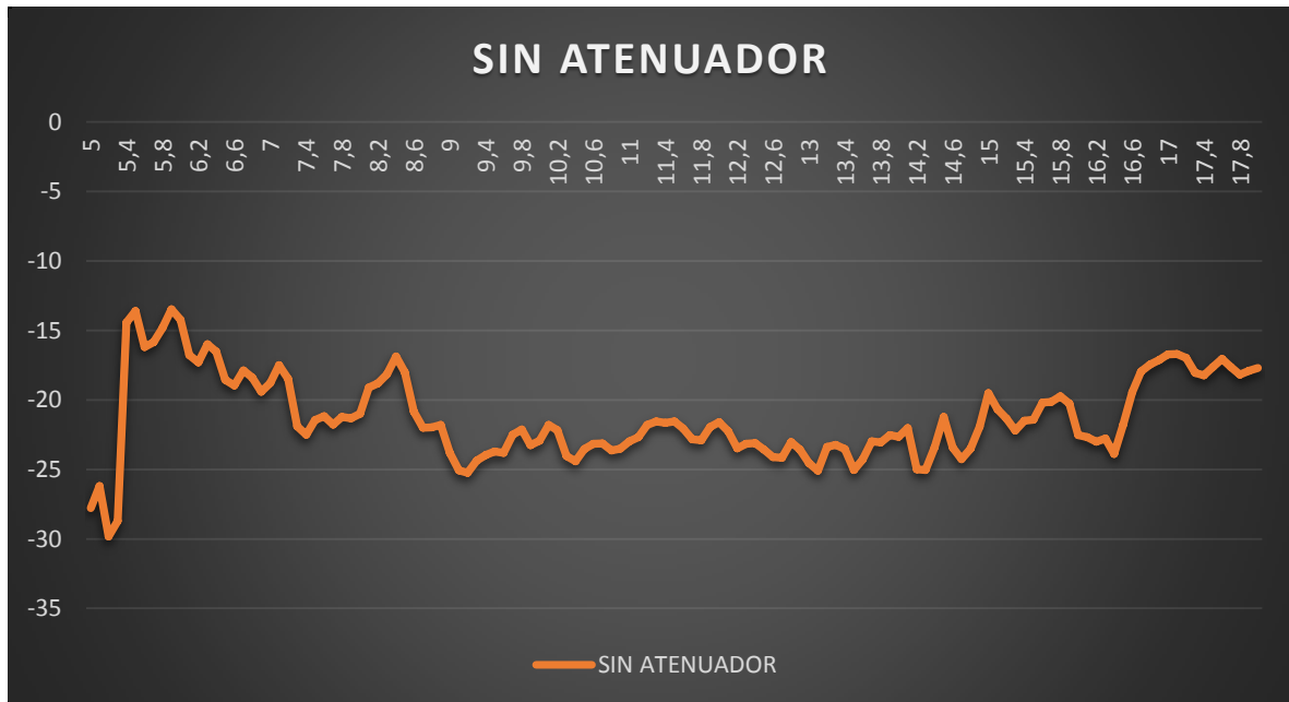
Figura 3-19: Gráfica de módulo de amplificación de 5-18 GHz
