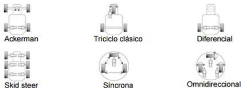
**Figura 7-2** Configuraciones de robots móviles de ruedas
