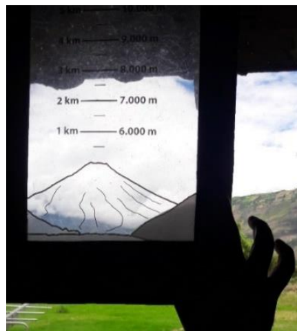
Figura 44-3: Regla de medición sobrepuesta en el horizonte Realizado por: Jaime Daniel Nasimba
