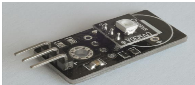
Figura 12-1. Sensor ultravioleta ARDUINO UVM30A Fuente: (Ventura, 2016)
