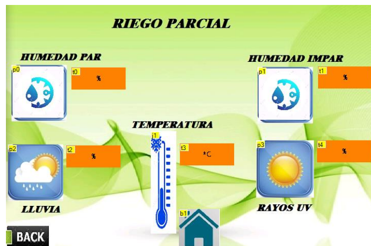
Figura 28-2: Monitoreo automático sensores HMI Realizado por: Kleber Chulde, 2017
