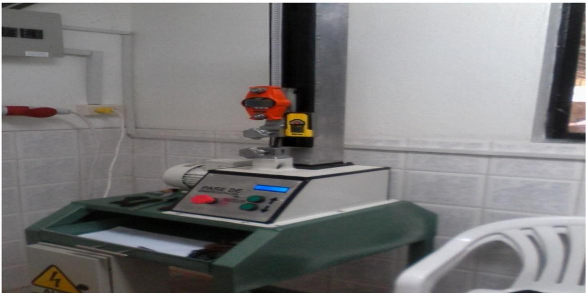
Figura 3. Equipo para el test de resistencia a la tensión.
