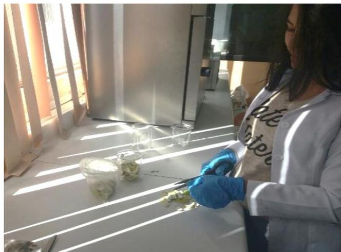
**Figura 5-3.** Reducción de tamaño del material bioadsorbente
