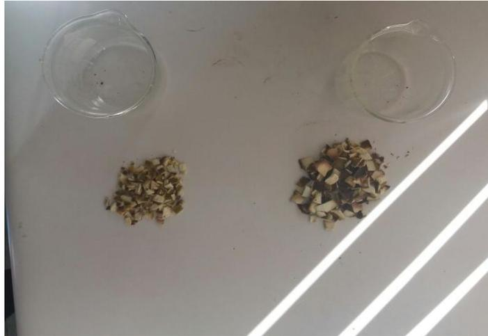
**Figura 8-3.** Reducción y clasificación por tamaños del material bioadsorbente
