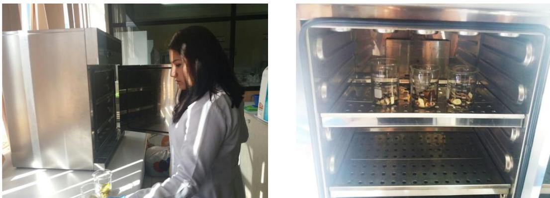
**Figura 7-3.** Secado del material bioadsorbente
