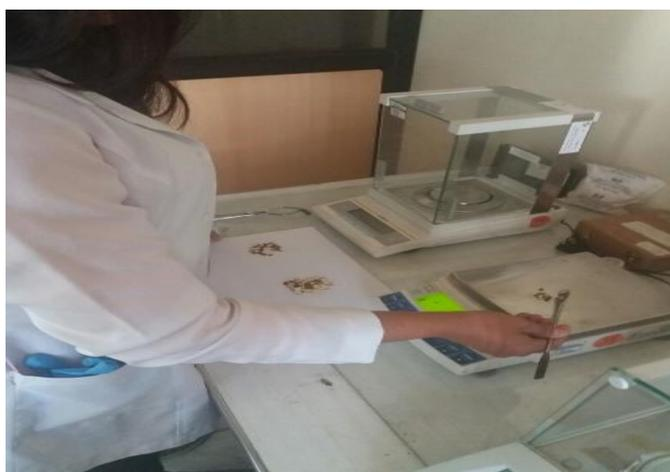
**Figura 12-3.** Pesaje del bioadsorbente
