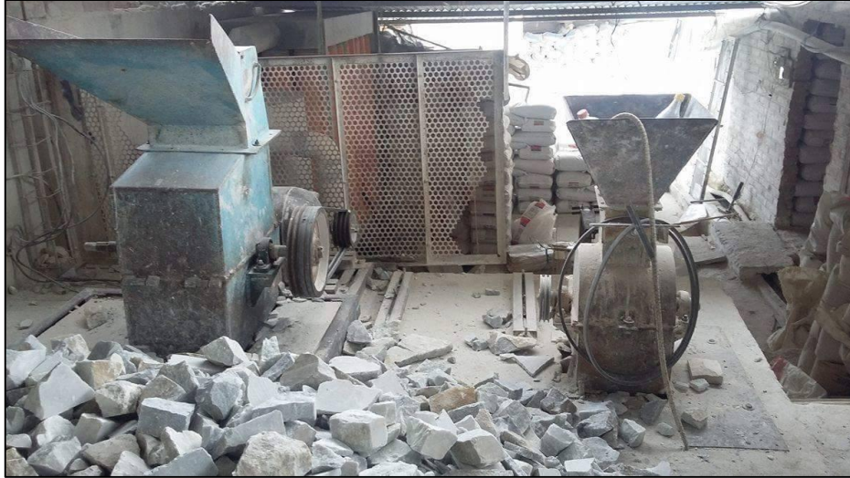
Fotografía 6-2. Triturador y molino utilizado en ECUAMARMOL
