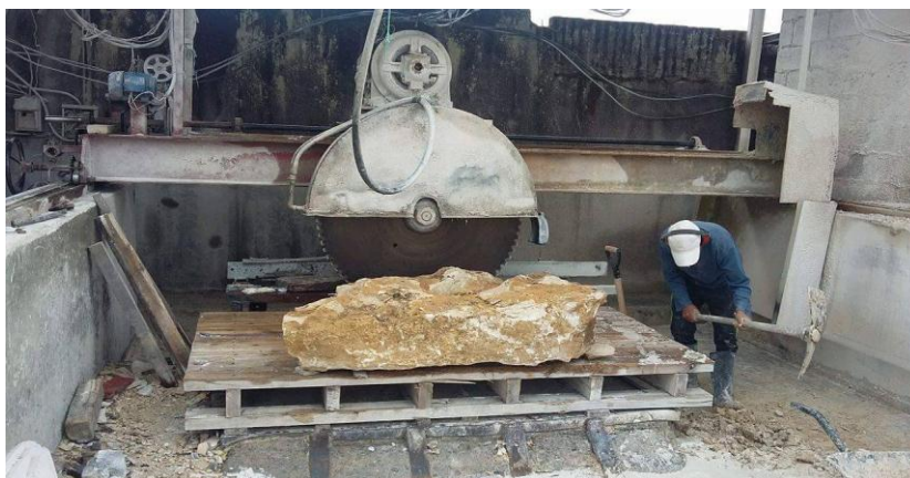
Fotografía 1-2. Bloqueadora (Cortadora 1) utilizada en ECUAMARMOL Realizado por: Manzano Dennis Renato
