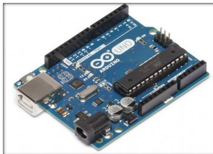
Figura 5-2: Arduino UNO- Aspecto Físico y Pines I/O Fuente: (Arduino, 2017, https://store.arduino.cc/usa/arduino-uno-rev3 ).
