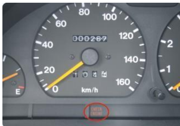
Figura 26-2. Identificación de Falla
