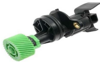
Figura 15-2. Sensor de la Velocidad del Vehículo
