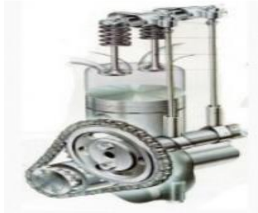
Figura 33-2. Sistema de Distribución
