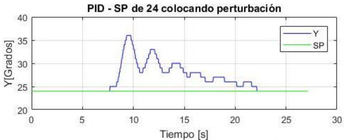
**Figura 3-4:** Control PID colocando sobrepeso cuando se encuentra en un SP de 24 grados.
