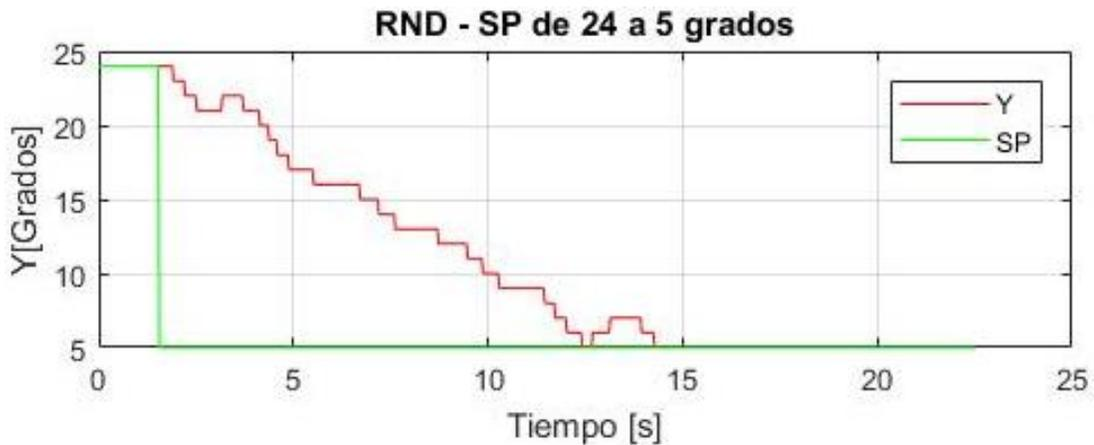
**Figura 6-4:** Control Neurodifuso bajando de un SP de 24 a 5 grados
