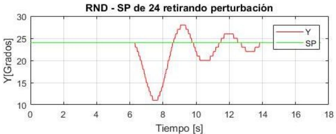
**Figura 8-4:** Control Neurodifuso retirando sobrepeso cuando se encuentra en un SP de 24 grados.
