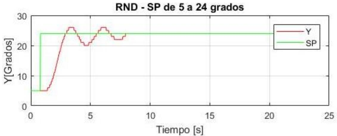
**Figura 5-4:** Control Neurodifuso subiendo de un SP de 5 a 24 grados.
