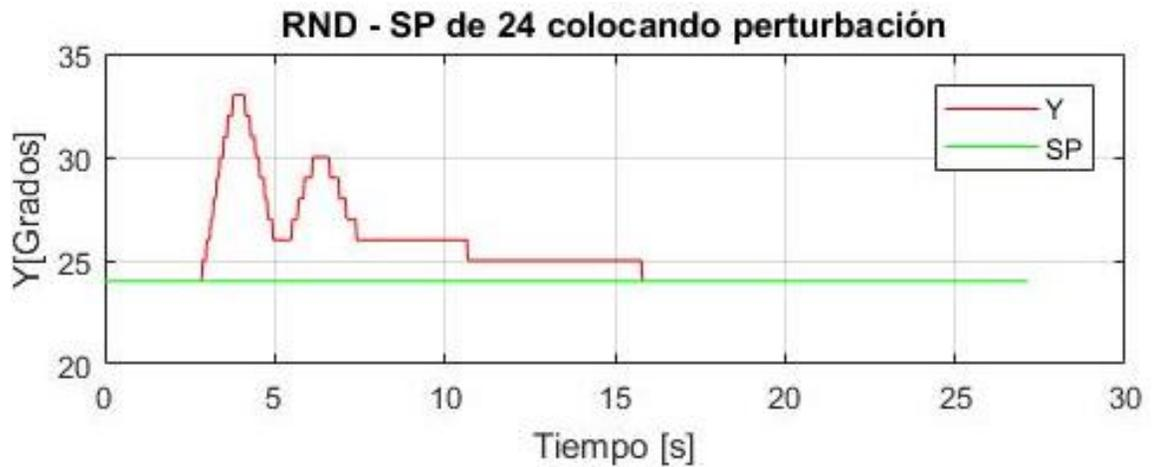
**Figura 7-4:** Control Neurodifuso colocando sobrepeso cuando se encuentra en un SP de 24 grados.
