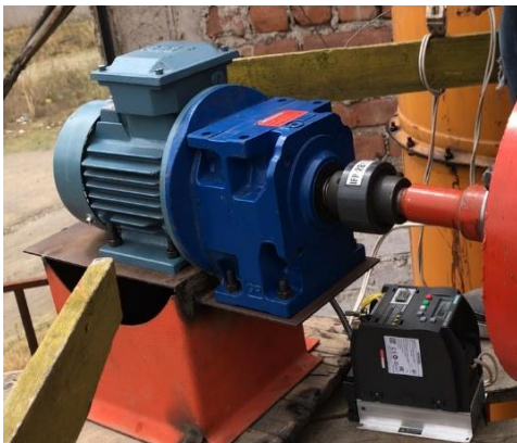
Figura 54-3: Motoreductor y variador
