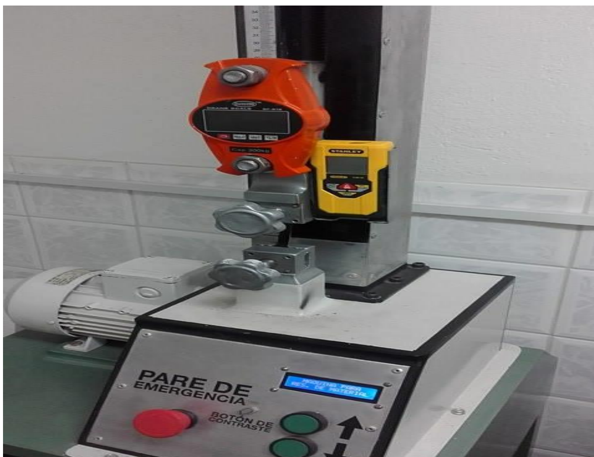
Fotografía 2. Partes de un equipo para realizar la medición de la resistencia a la tensión el cuero.
