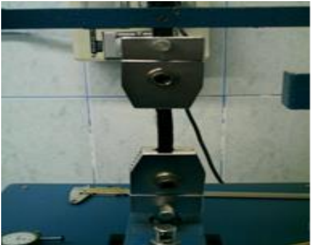
Fotografía 5. Colocación de la probeta de cuero entre las mordazas tensoras.
