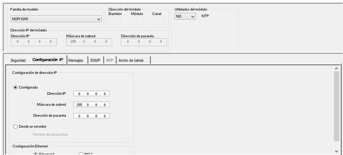
**Figura 23-3: Configuración de la conexión de red**
