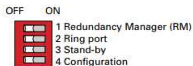
**Figura 26-3: Configuración mediante la selección del DIP/switch**
