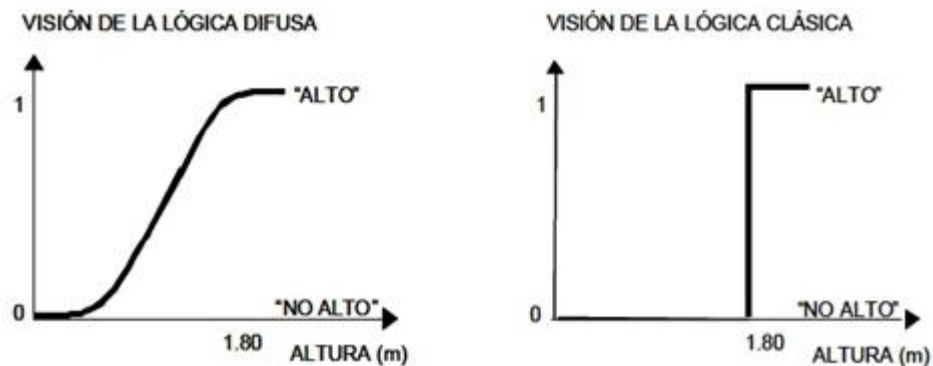
Figura 5 - 2 Visión de una variable de acuerdo a la Lógica Difusa y a la Lógica Clásica
