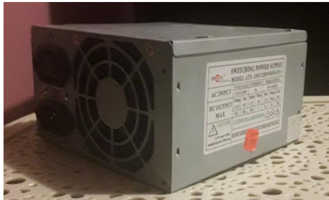
Figura 18 - 3 Fuente ATX utilizada como módulo de alimentación
