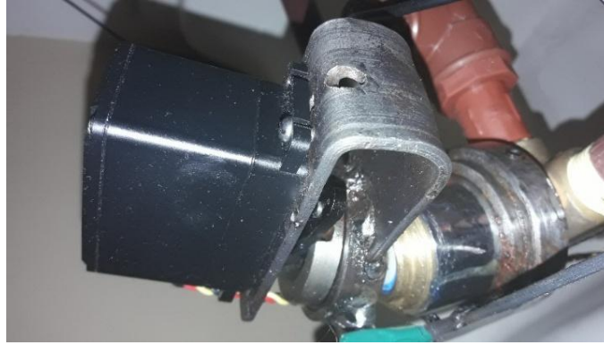
Figura 12 - 3 Servo motor acoplado al grifo monomando cerámico.
