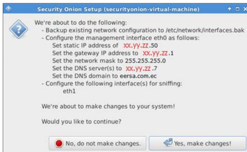
**Figura 28-2:** Resumen de Direccionamiento y configuración de Interfaces.
