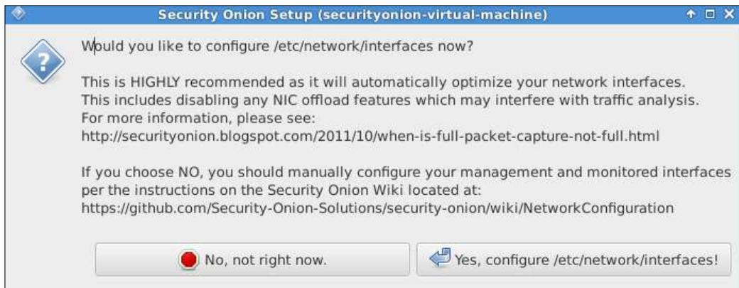
**Figura 21-2:** Configuración de Interfaces
