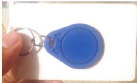
**Figura 7-2:** Tag llavero y tarjeta RFID
