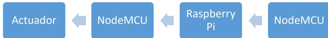
**Figura 21-2:** Bloques de dispositivos del mecanismo de salida
