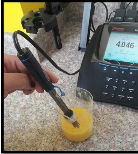
**Fotografía 10-3:** Medición de Ph en la pulpa
