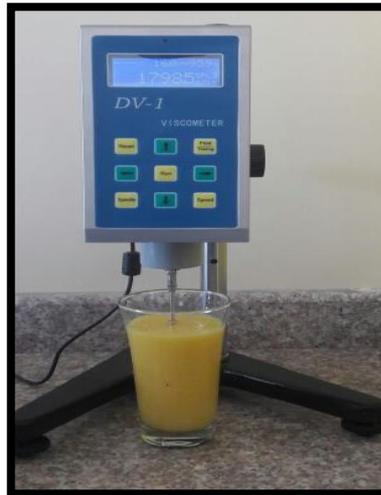
**Fotografía 11-3:** Medición de la Viscosidad en la pulpa
