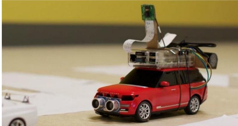
**Figura 7-1:** Coche Autónomo con Raspberry Pi
