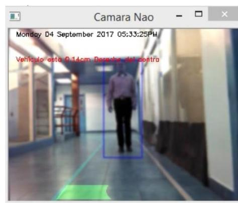
**Figura 7-4:** Robot sin acelerar detecta persona, frente al coche (al desplazarse)
