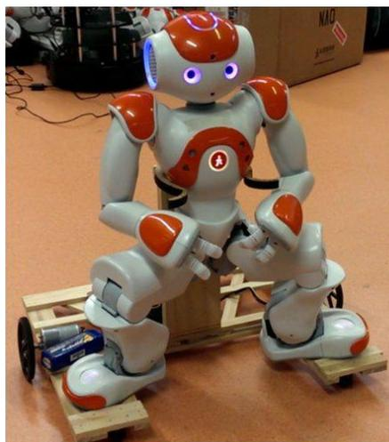
**Figura 5-1:** Robot NAO sobre un coche simple diseñado para la conducción
