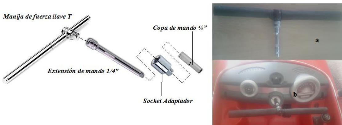
**Figura 6-3:** a) Mando armado volante, b) Mando montado en la columna dirección
